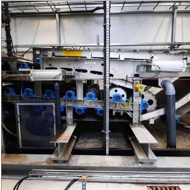
*Der Gärrest wird in einer Siebbandpresse entwässert. Der Feststoff mit einem Trockensubstanzgehalt von rund 30 Prozent wird von den Anwendern als Dünger, Kompost, Tiereinstreu oder als Biogas-Substrat eingesetzt oder verkauft.*
